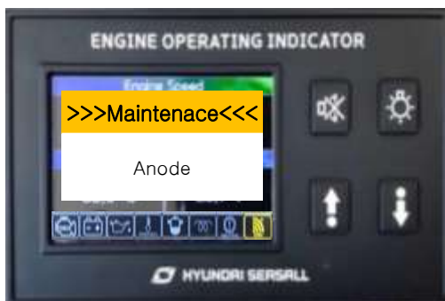
Case4 Service item alarm
